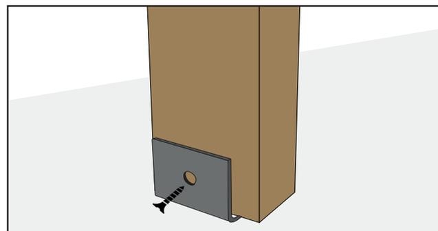
Pré-percer et **visser les profilés sur le côté** avec une vis plate noire.
